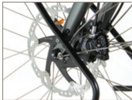
Shimano Ice-Tech 203 mm Bremsscheibe vorne
