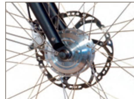
Vorderrad Naben-Motor Ansmann
