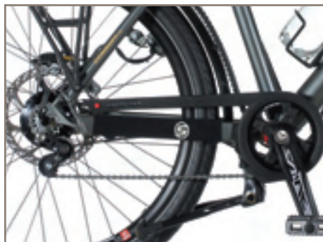
Rohloff mit Zee Kurbel und Chainglider Open
