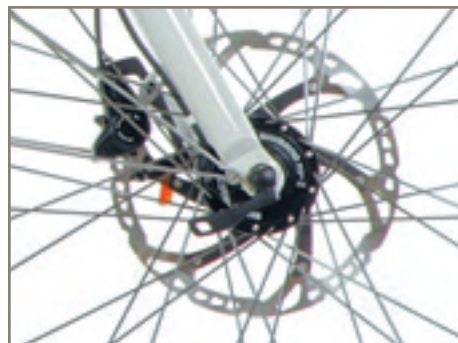
Shimano LX Scheibenbremse 203 mm
