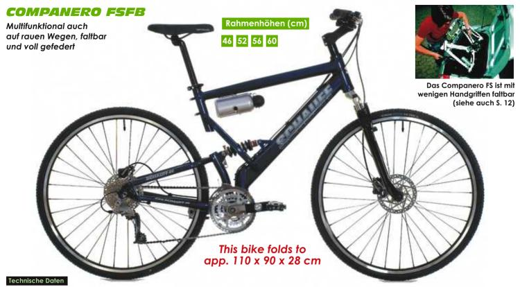
Rahmen: SCHAUFF Alu Techtube Set: Light 7020 T6 Aluminium, Square-Oval Unterrohr, faltbar, TIG-aeschweißt und heat-treated, Lagersitz nachgeschnitten und entgratet, IGUS Gleitlager, Oversize NCC Steuerkopfrohr.
