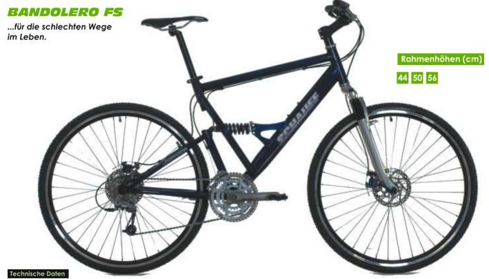
Rahmen: SCHAUFF Alu Techtube Set: Light 7020 Té Aluminium, Square-Oval Unterrohr, CrMo-URT, TIG-geschweißt und heat-treated, Lagersitz nachgeschnitten und entgratet, IGUS Gleitlager, Oversize NCC Steuerkopfrohr.
