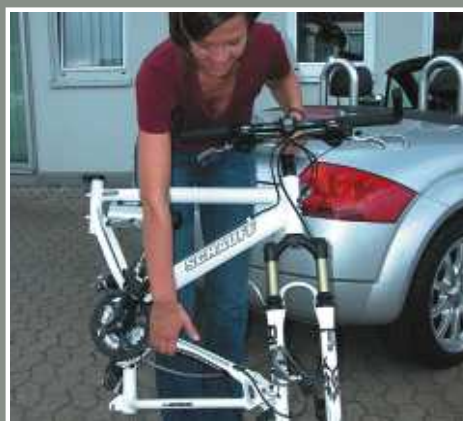
Lenker/Gabel um 90° drehen, Hinterbau einschwenken, Rahmen zusammenklappen
