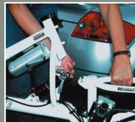
Schnellspanner des Dämpfers öffnen, ihn dann nach oben aus der Schwinge schwenken
