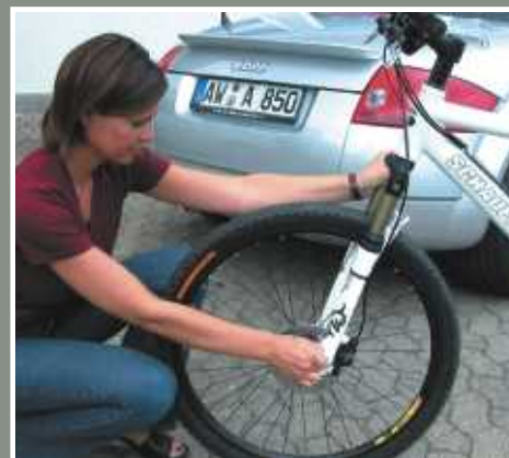
Pedale einklappen, Vorder-rad-Schnellspanner öffnen, Vorderrad entnehmen
