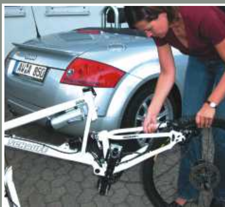
Hinterrad entnehmen, Sattel mit Stütze aus dem Rahmen ziehen
